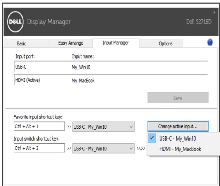
**注意：**即使顯示器正在顯示其他電腦中的視訊，DDM 也能與您的顯示器通訊。您可在經常使用的電腦上安裝 DDM 並控制輸入切換。您也可以連接顯示器的電腦上安裝 DDM。
